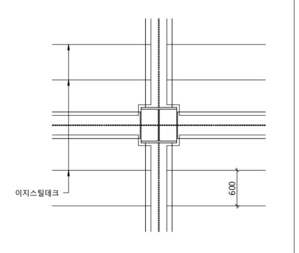
45 기동부분 DECK 설치 상세도 SCALE:NONE
